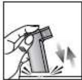
5. Secar completamente dentro e fora do dispositivo de plástico, deixando por uma noite sem o recipiente metálico e capa de proteção, ou utilizando um jato de ar quente. Certifique-se de que o bocal está completamente seco antes do uso.
