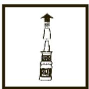
2. Retirar a trava de segurança e remover a tampa protetora. A válvula já se encontra encaixada.
